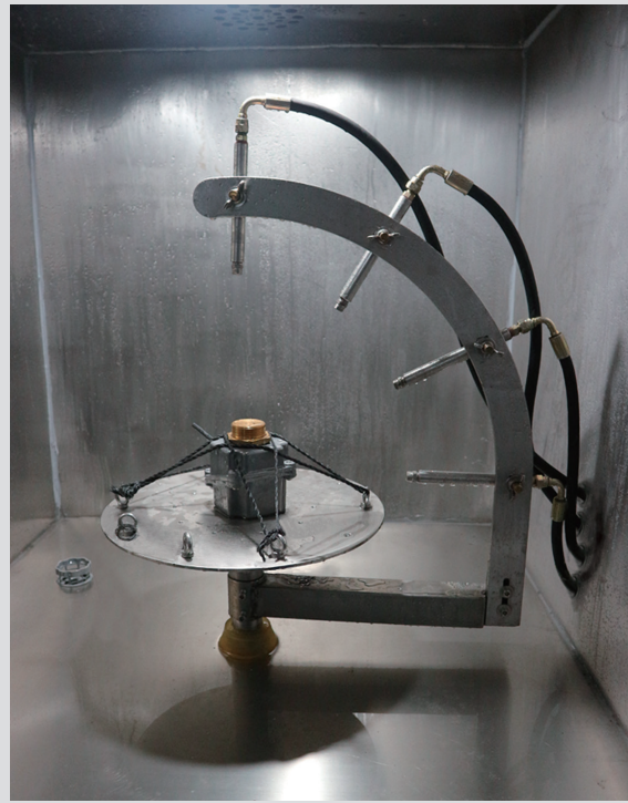
Boitier en cours d'essai IPx9K
